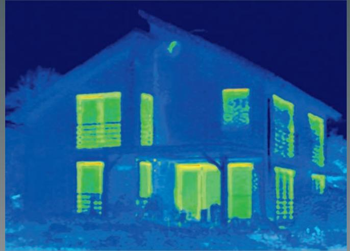
Nach dem sorgfältigen Einbau neuer Fenster aus unserem neuen Fenstersystem beweist die Thermografie den hohen energetischen Nutzen der Investition. Der ursprüngliche Energieverlust wird nahezu vollständig vermieden.
